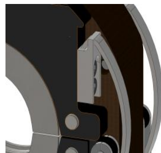
Sistema de mola ajustável: para se adaptar a tubos ovalizados
