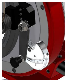
Sistema de Guia Exterior: para correção de ovalização
