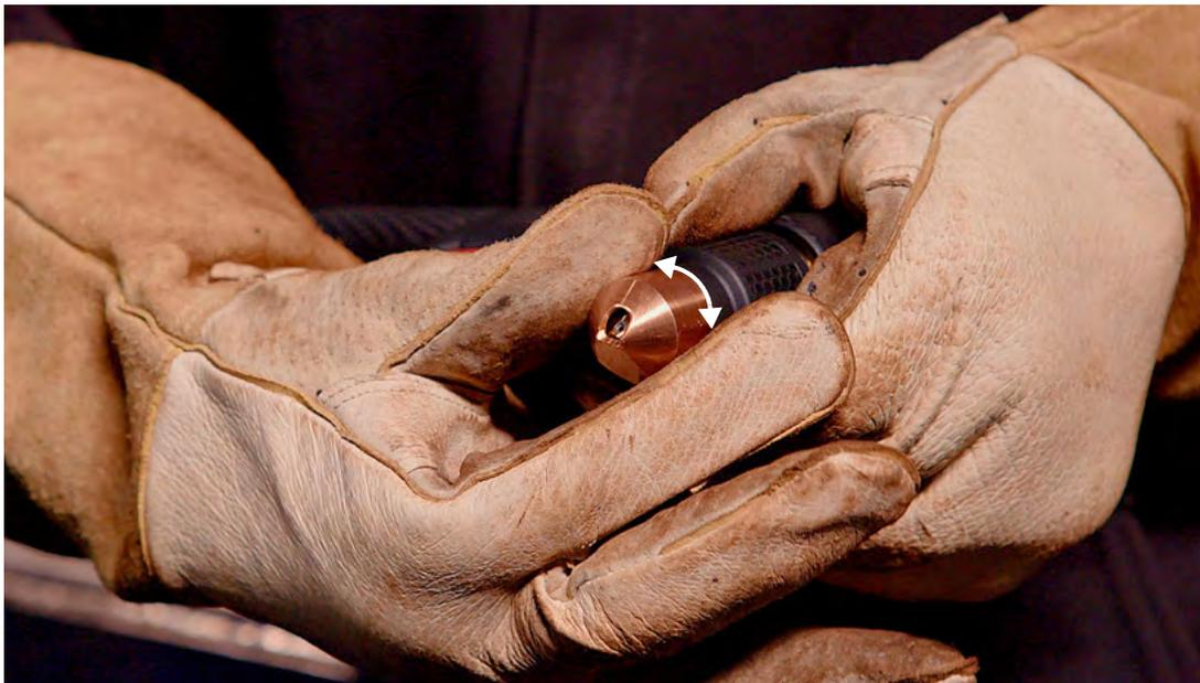
2. Confirme se o lado plano da ponta do cartucho está alinhado com o lado plano da peça de trabalho. Ajuste conforme necessário.
