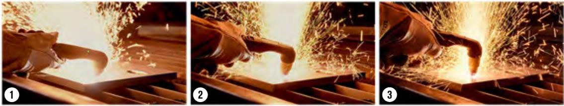
**4.** Mantenha a tocha em posição enquanto continua a pressionar o gatilho. As faíscas que saírem da parte de baixo da peça de trabalho indicam que o arco perfurou o material.
