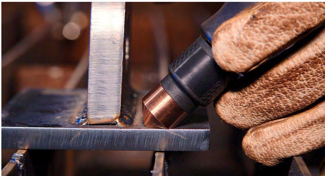
7. Pressione o gatilho da tocha para iniciar o arco. Mantenha a tocha na posição até o arco transferir para a peça de trabalho vertical e tenha sido efetuado o corte completo. O arco é efetuado por completo quando saem faíscas do outro lado da peça de trabalho vertical.
