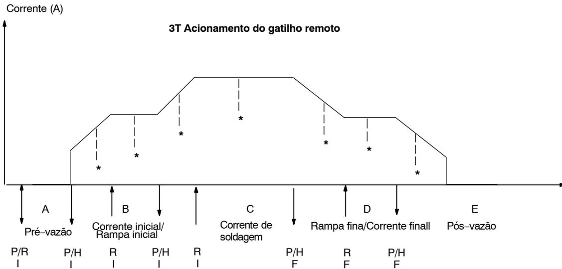
\* O arco pode ser interrompido a qualquer momento apertando e soltando ambas as chaves inicial e inal ou levantando a tocha e quebrando o arco.
