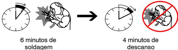
250 A @ F.T. = 60% para Eletrodo Revestido
